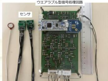
局所筋疲労評価のためのワイヤレス積層型マルチセンサシステム
